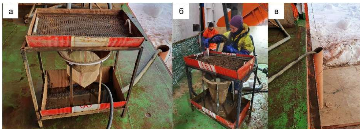
Рис. 3. Общий вид системы для промывки бентосных проб (а, б) и организация стока воды (в)
